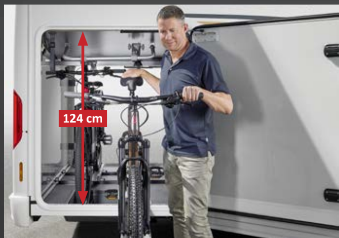
Större lasthöjd genom att enkelt fälla upp bakre sängen med en hand och extra nedsänkt golvdel
