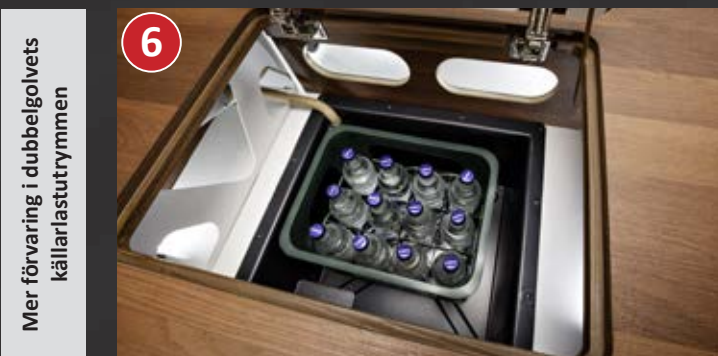
Lucka i bodelsgolvet till stuvbox i dubbelgolvet (42 cm nyttjandedjup) i uppvärmt dubbelgolv
