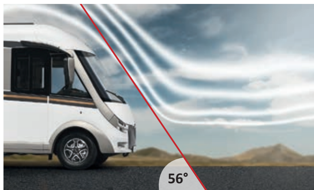
Tredimensionell, lutande front för mindre luftmotstånd, lägre bränsleförbrukning och mindre vindljud
