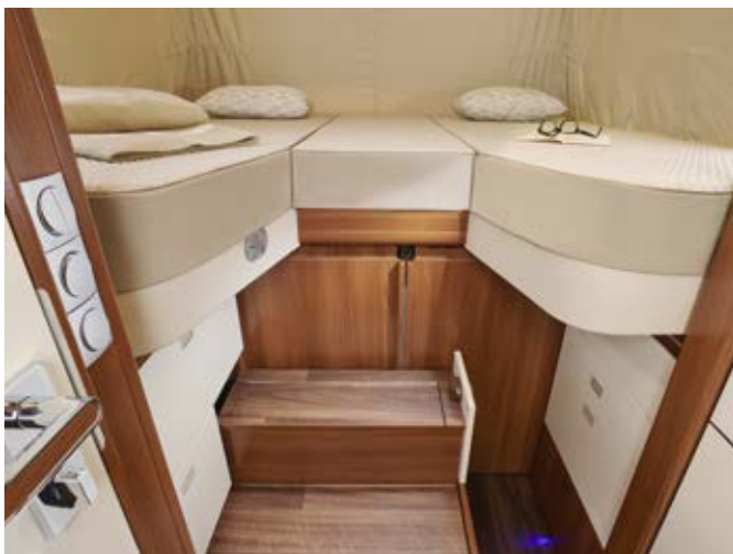
Elektriskt nedsänkbara enkelsängar på längden med utdragbar sängtrappa och skjutdörrar för att avgränsa kyla
